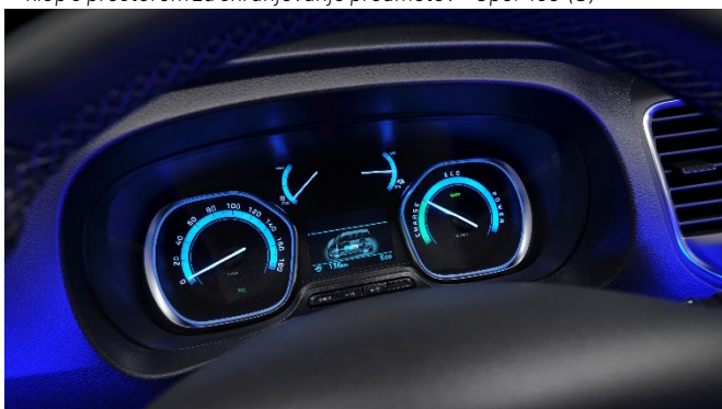
Osrednji informacijski 3,5-palčni TFT zaslon med merilniki (BEV) - Opc. JAU
